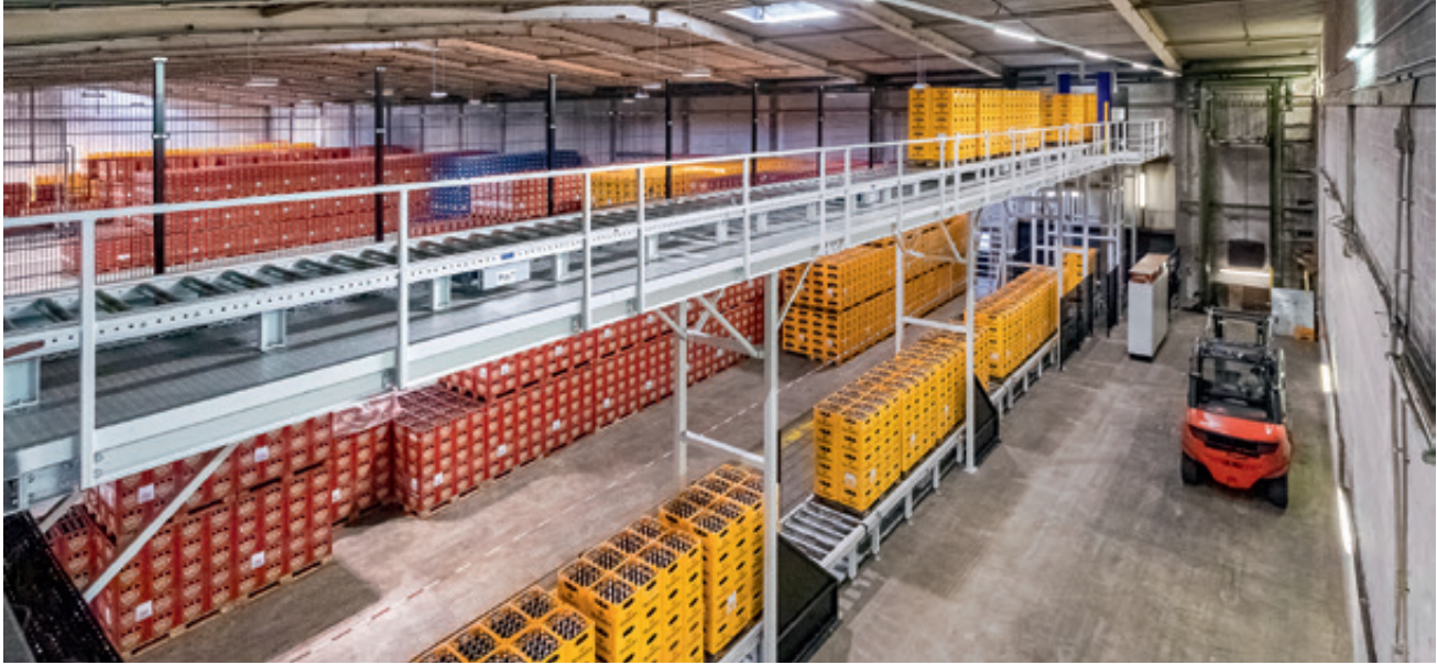
Die Rollenbahn hat einen Pufferplatz für bis zu 50 Paletten, die aufgenommen werden können, ohne dass die Produktion ins Stocken gerät. (Bild: HaRo)
