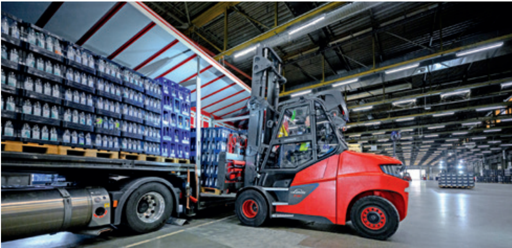
Die Elektrostacker Linde E80 transportieren mit 6-fach-Klammern fertige Paletten mit Kästen von der Anlage ins Blocklager oder direkt auf die Transport-Lkw, bzw. versorgen die Abfüllung mit Leergut-Kästen. (Bild: Jungbluth Fördertechnik)
