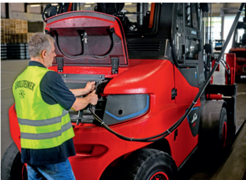
Die Linde E-Stacker werden mit Li-ION-Batterietechnologie angetrieben. (Bild: Jungbluth Fördertechnik)
