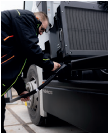
Die durch Saga integrierte Schnelllade-Infrastruktur, die für den Betrieb der Strecken aufgebaut wurde, basiert auf der Kempower-Ladelösung. (Bild: Heineken Deutschland)
