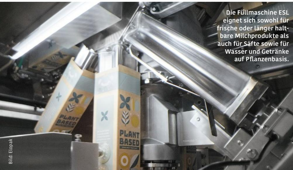
Die Füllmaschine ESL eignet sich sowohl für frische oder länger haltbare Milchprodukte als auch für Säfte sowie für Wasser und Getränke auf Pflanzenbasis.
